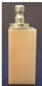
Fig. 1. Bloco em resina multi-color para o sistema CAD/CAM.
